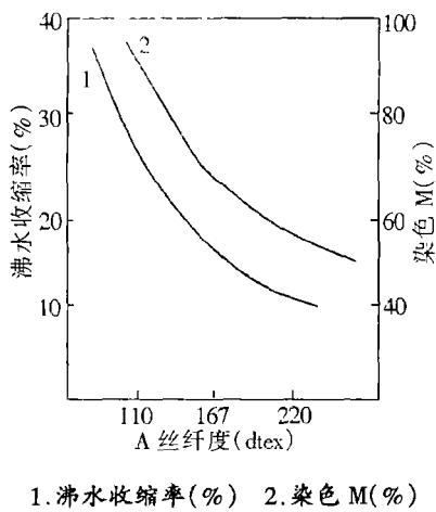
图 1 A 丝纤度与复合丝沸水收缩率、染色 M 率关系 (B 丝纤度 110 dtex/qfb)
