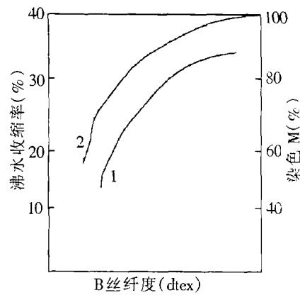
图 2 B 丝纤度与复合丝沸水收缩率、染色 M 率关系 (A 丝纤度 125 dtex)
