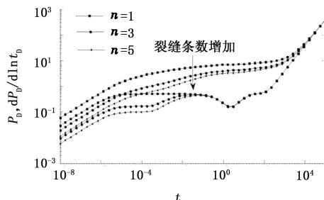
图 11 裂缝条数  $n_f$  对压裂水平井井底压力的影响
