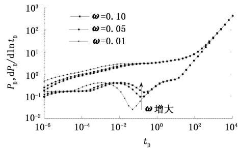
图10 弹性储能比对压力动态的影响
