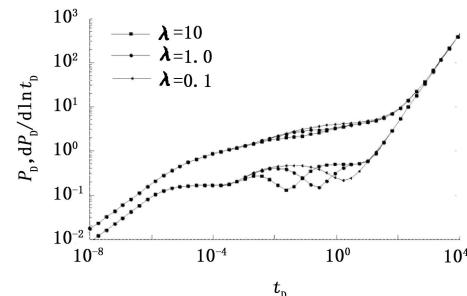
图9 窜流系数对压裂水平井井底压力的影响
