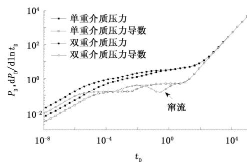
图 2 不同介质类型压裂水平井压力动态对比
