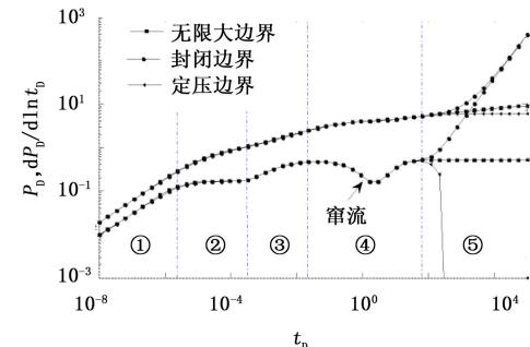
图 3 不考虑井储和表皮的压裂水平井井底压力动态曲线
