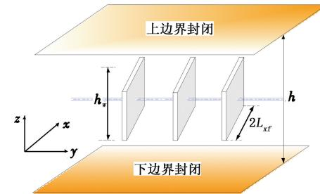
图 1 水平井穿过多条裂缝示意图
