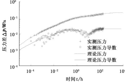
图 14 测试井理论曲线与实测曲线双对数拟合图
