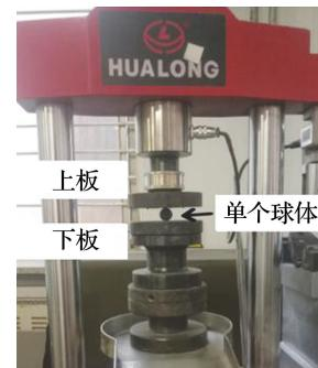
图 3 单颗粒破碎试验装置
