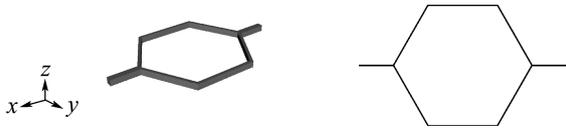
图3 采用梁单元离散的六角形蜂窝单胞
