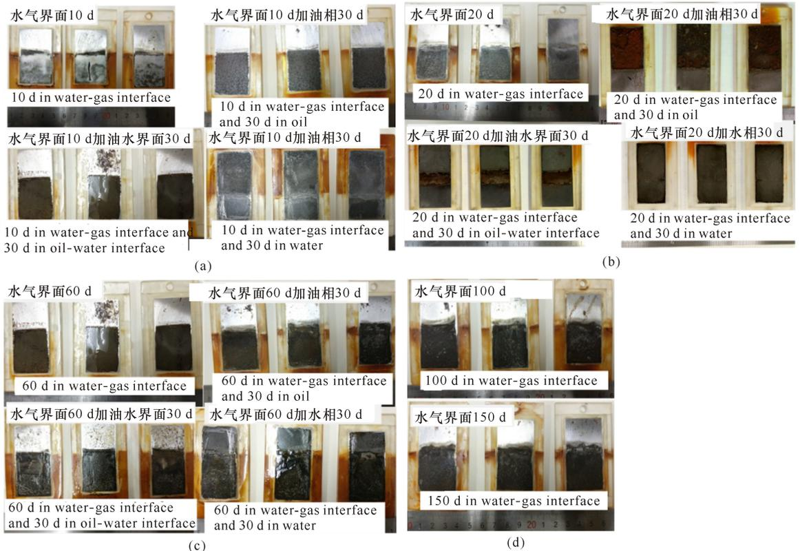
图3 X65 管线钢水线腐蚀宏观形貌
