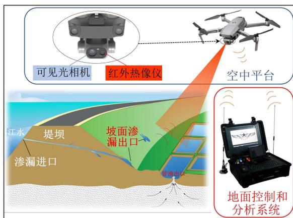
图1 无人机载红外-可见双光成像的堤坝渗漏巡查模式示意图
