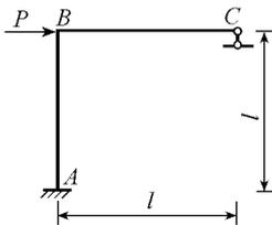
图 1 超静定刚架结构
