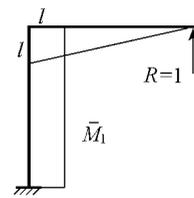
图 4 单位荷载弯矩  $\bar{M}_1$
