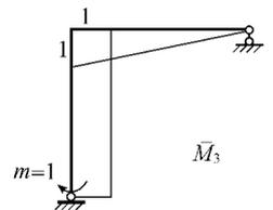
图7 单位荷载弯矩  $\bar{M}_3$
