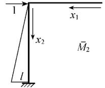
图 5 单位荷载弯矩  $\bar{M}_2$
