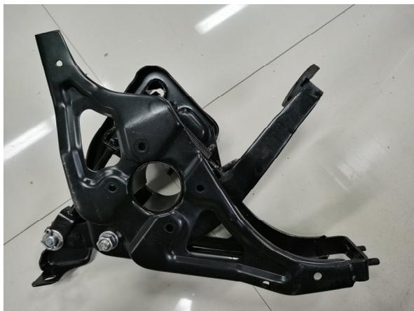
图 15 制动踏板总成优化方案样件
